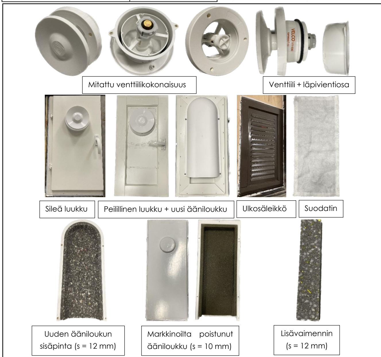
Kuva 1. Kuvia mitatusta venttiilikokonaisuudesta, tuuletusluukusta ja äänenvaimennusosista.
